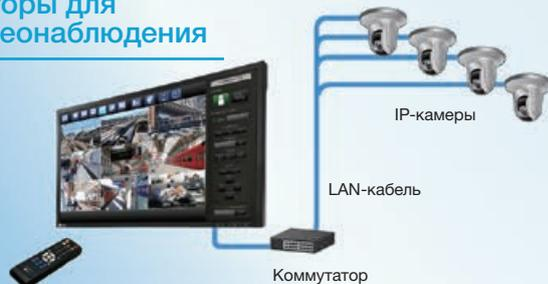
IP-решение от EIZO обеспечивает прямое подключение монитора к нескольким IP-камерам для эффективного управления видео в системах безопасности и видеонаблюдения
