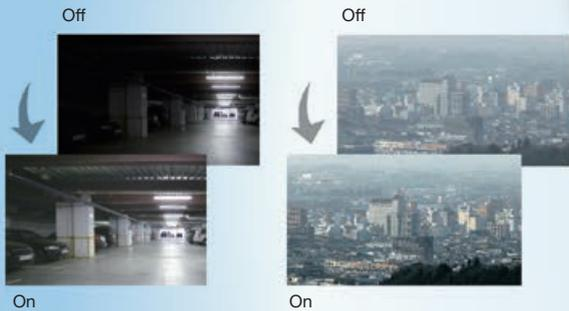
Технология оптимизации изображения от EIZO включает три функции для повышения четкости изображений. Функция, предотвращающая запотевание, улучшает изображения, которые становятся нечеткими из-за тумана или снега. Коррекция темного места изображения — определяет слишком темную область экрана и подстраивает яркость каждого пикселя. Функция удаления шума — устраняет цифровой шум при корректировке нечетких зон.
