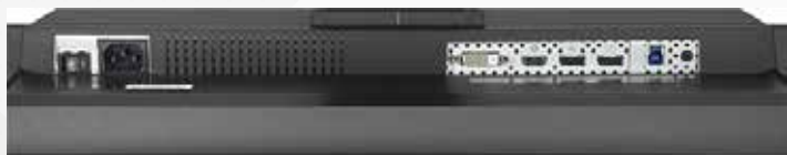
Входные порты 4К-монитора на примере FlexScan EV3237. Слева направо: DVI-D, HDMI и два DisplayPort 1.2. Справа от них линейный вход и порт USB 3.0.
