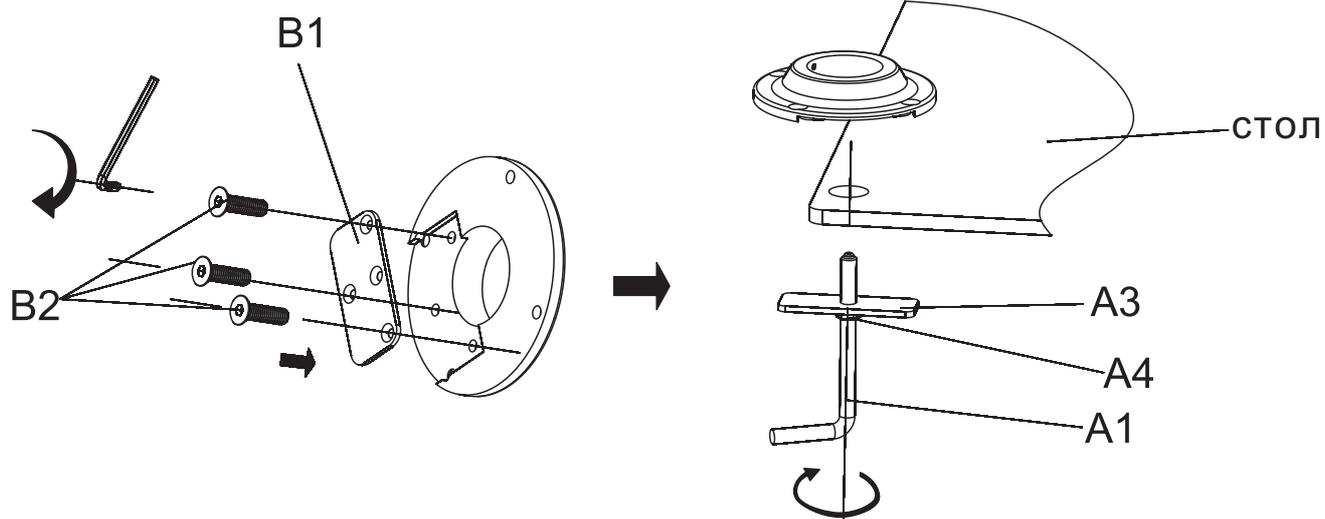
Необходимо предварительно подготовить отверстие в столешнице диаметром 10 мм (мин) - 80 мм (макс)
